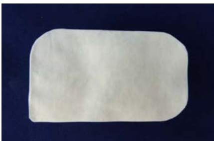
Figure 1 : Couvercle Tyvek du blister interne du dispositif Prodisc-C Vivo
