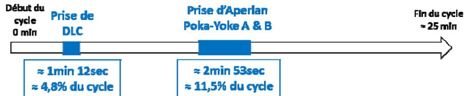
Durée du cycle de retraitement d'un endoscope et de prise produit dans un ED-FLOW / ED-FLOW SD
