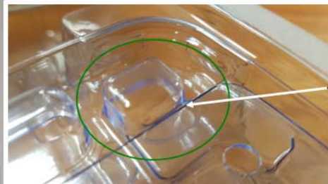
Figure 2 – Plaque de support PETG bien clipsée
