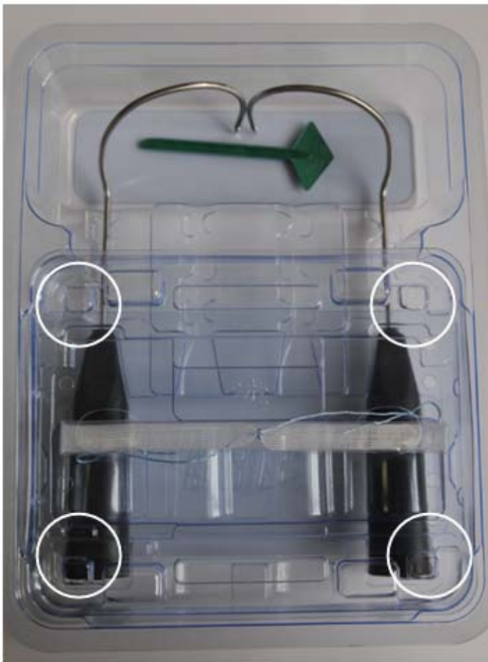
Figure 1 – Plaque de support en PETG bien clipsée
