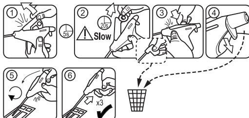
Das Produkt muss korrekt aktiviert und der Klebstoff richtig angesaugt werden, um zu gewährleisten, dass das System korrekt funktioniert.
