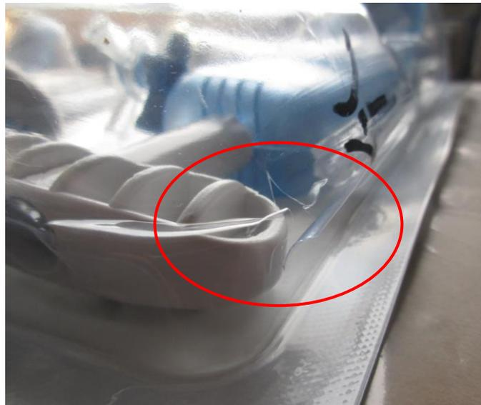
Image 1 : exemple de fissure observée près de la poignée du dispositif de gonflage
