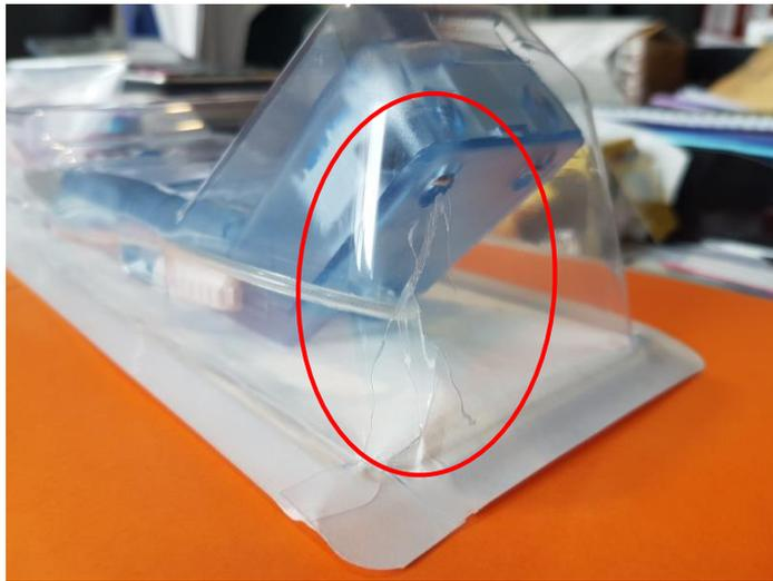
Image 2 : exemple de fissure observée près de la jauge de pression du dispositif de gonflage
