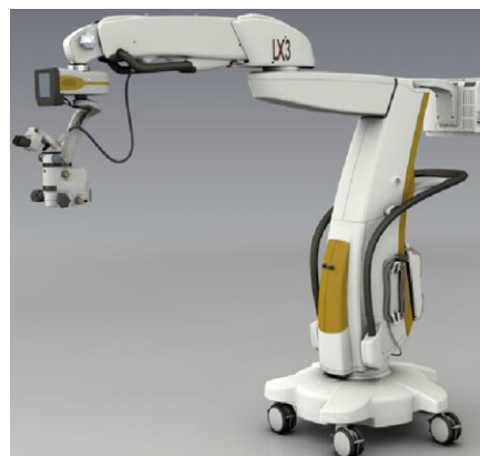
Figure 2 Bras articulé du microscope en position étendue
