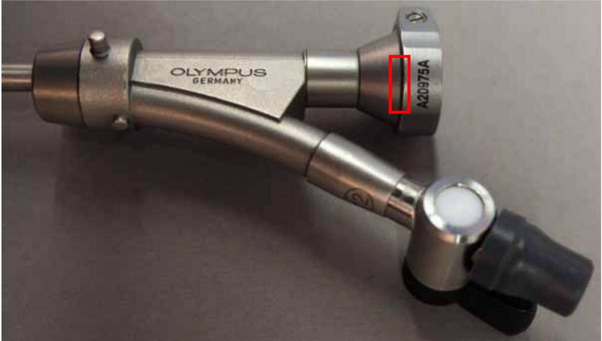
Image 3 : numéro de modèle sur le passe sonde
