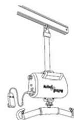
Méthode 2: Fixation rapide Q-Link (sangle) fixée au chariot S65
