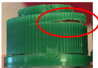
Image 1 Capuchon vert fissuré
