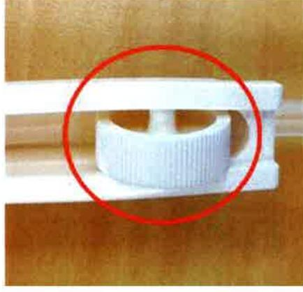
**Non conforme : la roulette est "de travers", la partie droite est sortie de son axe**
