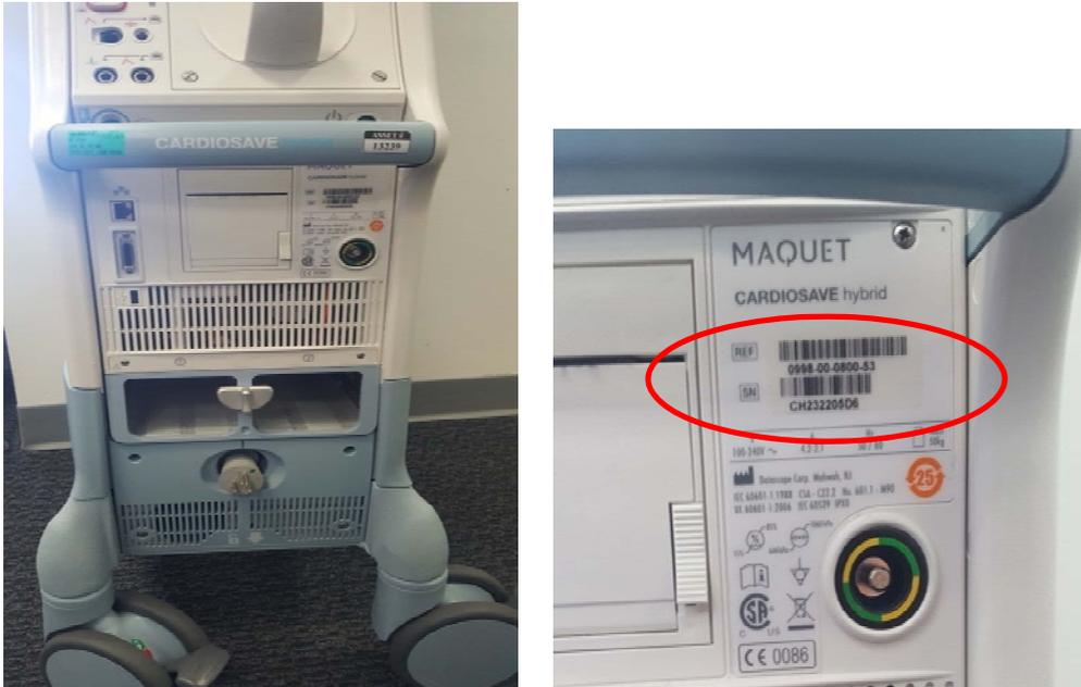
**Figure 1 : Console CARDIOSAVE – Emplacement de la référence (REF) et du numéro de série (SN)**
