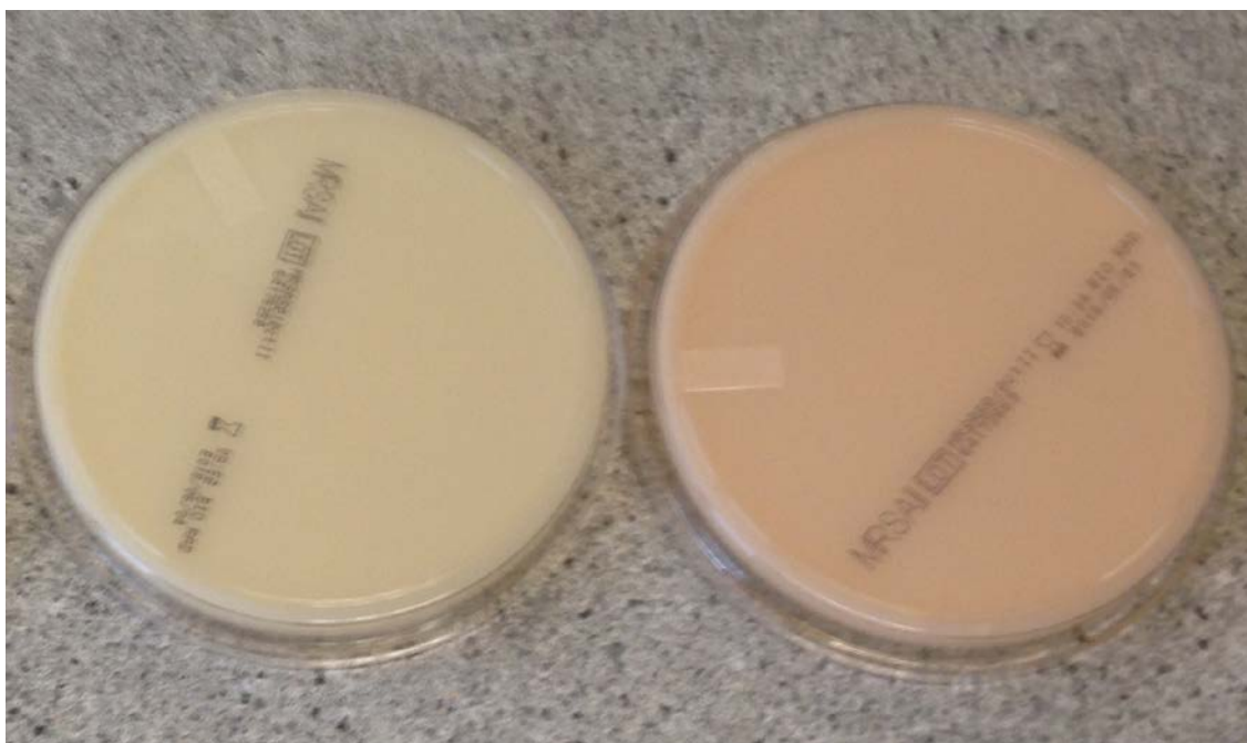
A gauche : couleur conforme A droite : couleur non-conforme, nuance rose-orangée
