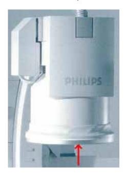
L'anti-collision fonctionne correctement si le mouvement s'arrête immédiatement.
