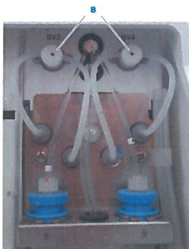
Type 3 assy (présence de points noirs sur les pinch valves)
