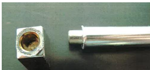
Figure 2 : vue du problème lié à la tige droite filetée
