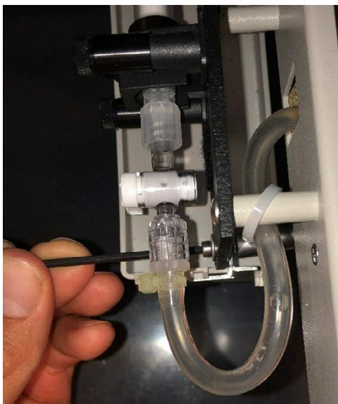
**Remarque :** pour amorcer le robinet (si nécessaire), inclinez le plateau de seringue en le poussant contre la seringue, puis vers le bas. Le plateau va s'incliner vers l'arrière pour atteindre, par la force du ressort, la position horizontale et se verrouille dans cette position. Figure 10
