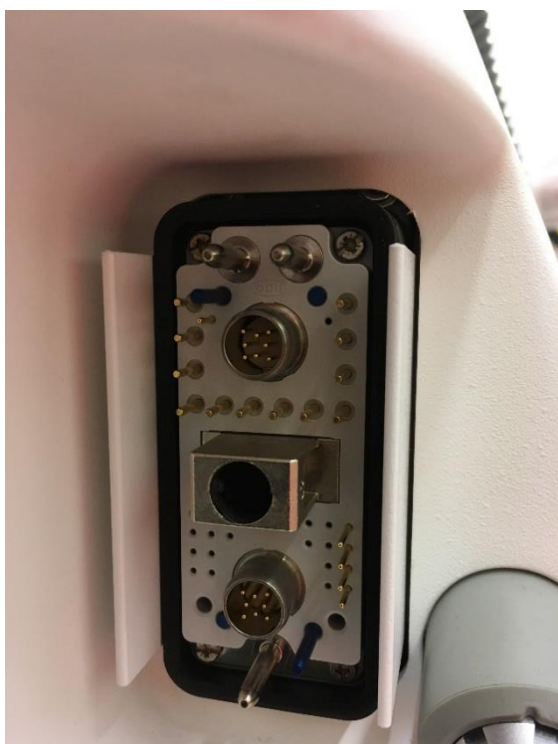
figure 3 : exemple de prise X10 avec fiche du câble principal non branchée
