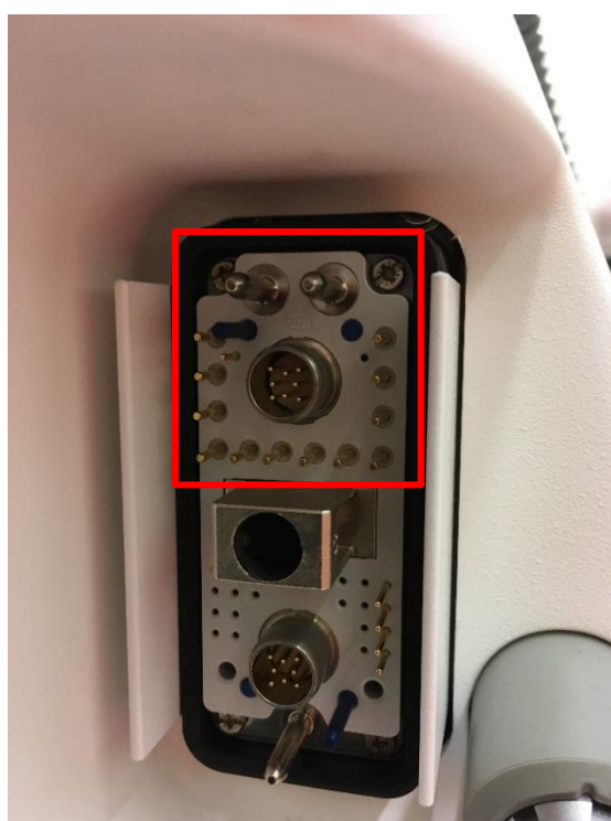
figure 2 : exemple de prise X10 avec zone des broches de contact à ne pas toucher
