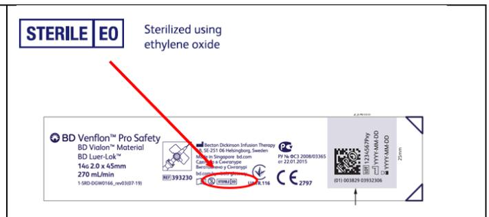
**Figure 2** : Représentation de l'étiquette du produit indiquant la méthode de stérilisation à l'oxyde d'éthylène
