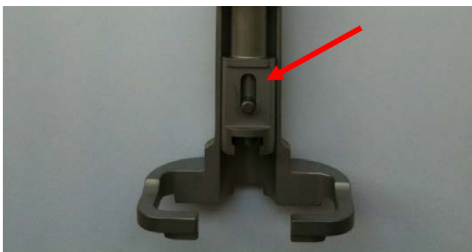
Fig. 2: Vue de face, gros plan de la gâchette
