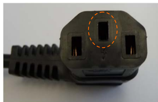
Figure 2 : Connecteur femelle non-conforme.
