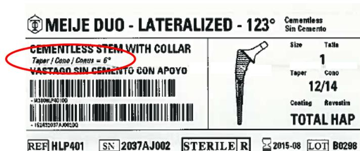
Une confusion peut survenir dans le cas de la lecture des deux descriptions de cône. Dans tous les cas, les tiges 12/14 ne peuvent pas s'assembler à des têtes cône 6°. Les tiges 12/14 sont livrées avec des têtes fémorales 12/14, l'établissement dispose donc toujours des composants compatibles entre eux.
