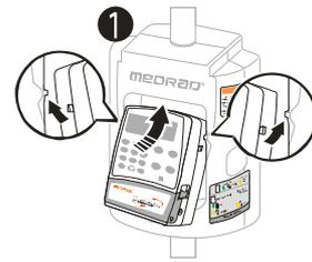
2. Faites tourner la partie inférieure de la pompe dans le support (cf. schéma 2). Assurez-vous que chaque pompe est bien retenue dans le support pour éviter qu'elle ne tombe tant que la vis de fixation n'est pas serrée.
