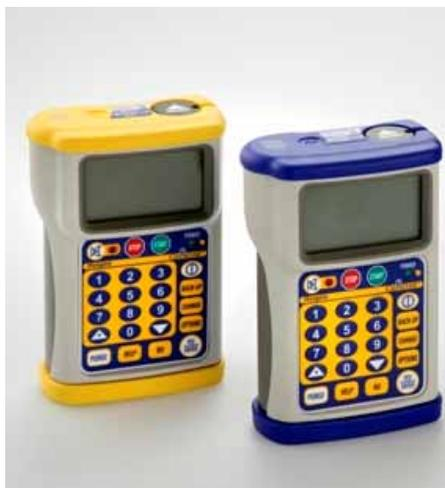
Les analyses menées par la société Hospira ont permis de déterminer que la cause probable à l'origine de ce problème serait la force exercée sur le cordon lors de son retrait de la pompe GEMSTAR™. En effet si une force excessive est appliquée sur le cordon, l'extrémité de celui-ci risque alors de s'effiloche ou de se casser.
