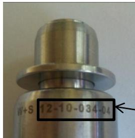
Exemple de numéro de série du module dynamométrique
