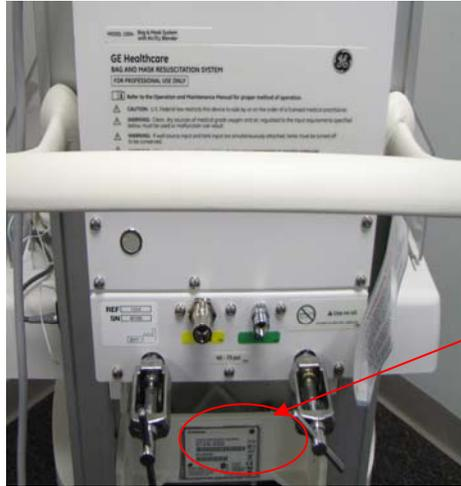
Emplacement des raccords et des étiquettes d'air et d'oxygène à l'arrière de l'unité (l'air est toujours à gauche et l'oxygène est toujours à droite).
