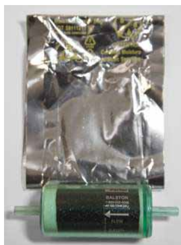
Les cartouches d'adsorption de vapeur VITROS® contiennent des granules de carbone noirs et sont emballées dans un sac argenté pour assurer leur protection.
