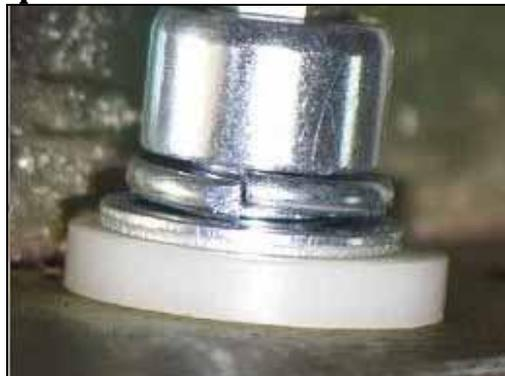
6) Si les vis sont mal positionnées, n'utilisez plus le système et contactez votre ingénieur de maintenance pour réparation.
