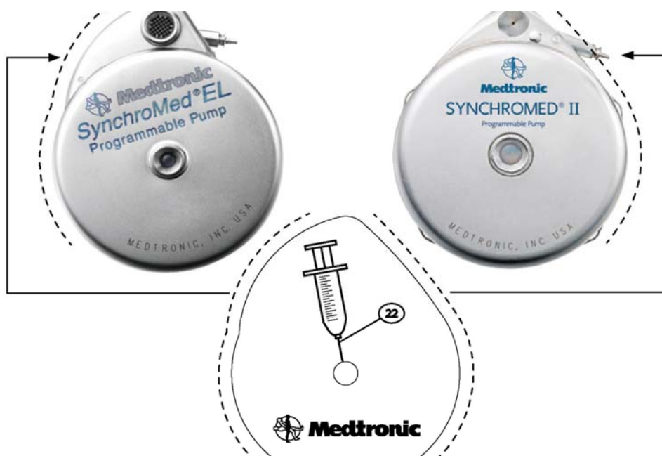
Figure 1. Alignement correct du gabarit de remplissage pour chaque modèle de pompe
