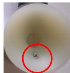
(\*) Les doigts de verrouillage usés en quelques semaines ont l'aspect suivant ci-contre et seront remplacés par des doigts de qualité renforcée référencés :
