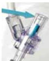
Suite à des contrôles internes, il a été détecté sur quelques unités, la présence d'une fuite au niveau de la valve en Y Safsite, après déconnexion du set de perfusion. Cette fuite est induite par la fermeture incomplète de la valve (voir schéma ci-contre). Le disque en silicone ne revient pas en position fermée après la déconnexion de l'embout mâle luer. Il n'est pas possible de visualiser le défaut sur des valves non utilisées ou connectées.
