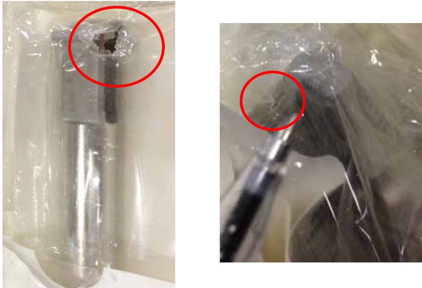
Figure 2 : Sachets endommagés des composants de la prothèse de genou à charnière rotative S-ROM® Noiles
