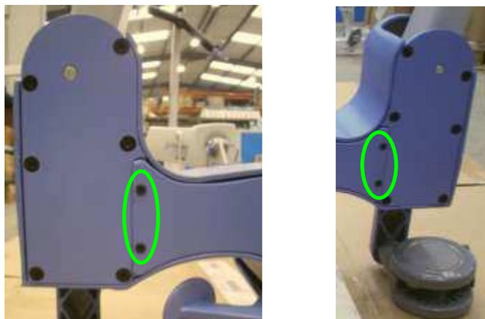
Si au contraire les vis de l'embase de votre lève malade sont argentées et correspondent à la photo de vis type 3, celles-ci doivent être remplacées (voir photo ci-dessous).
