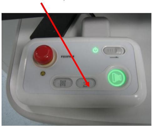
Cette décompression ne fonctionne qu'avec une alimentation électrique. En cas de blocage logiciel ou de coupure de courant, **PASSEZ AU DEBLOCAGE MECANIQUE** page suivante.
