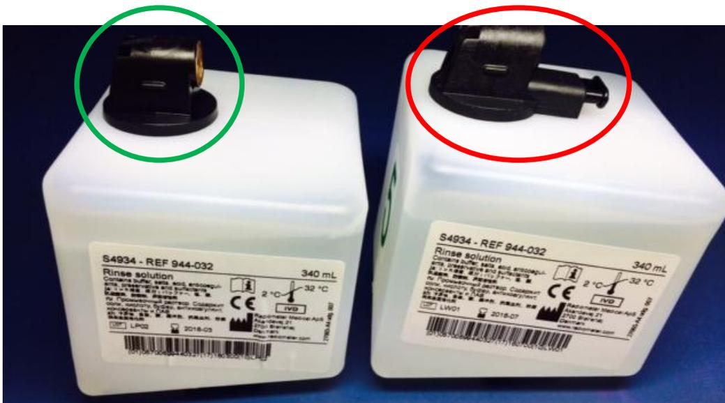
La bouteille de gauche est équipée d'un adaptateur conforme tandis que la bouteille de droite est munie d'un mauvais adaptateur.
