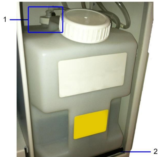
Figure 2. Bouchon de 38 mm fixé solidement sur le flacon d'eau
