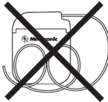
Figure 3. Enrouler tout excédent de l'extension autour du périmètre du neurostimulateur.
