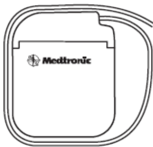
Figure 3. Enrouler tout excédent de l'extension autour du périmètre du neurostimulateur.
