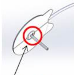
Point de rupture de l'aiguille
