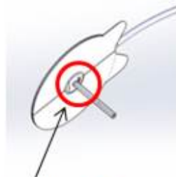
Point de rupture de l'aiguille
