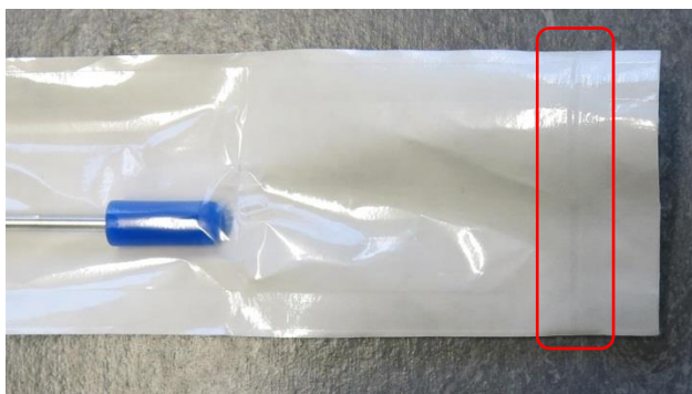
Exemple de sachet stérile avec sellage potentiellement non conforme.
