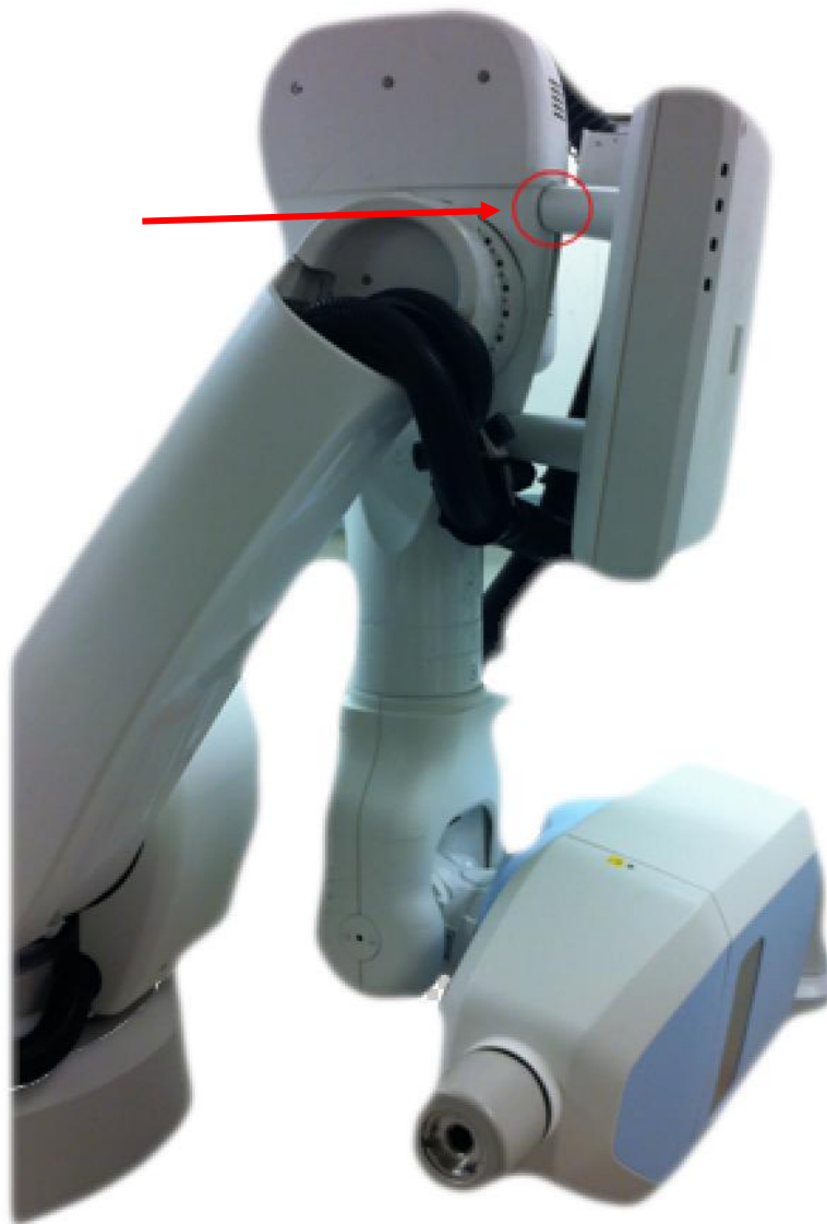
Figure 2 : Support du châssis du boîtier de contrôle du canon à électrons (« Gun Box Mounting Bracket ») en position verticale
