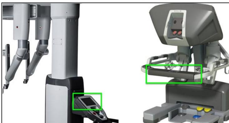
Figure 1. Emplacement du pavé tactile sur le Chariot Patient du système *da Vinci* Xi (à gauche) et sur la Console du Chirurgien des systèmes *da Vinci* Si et Xi (à droite).
