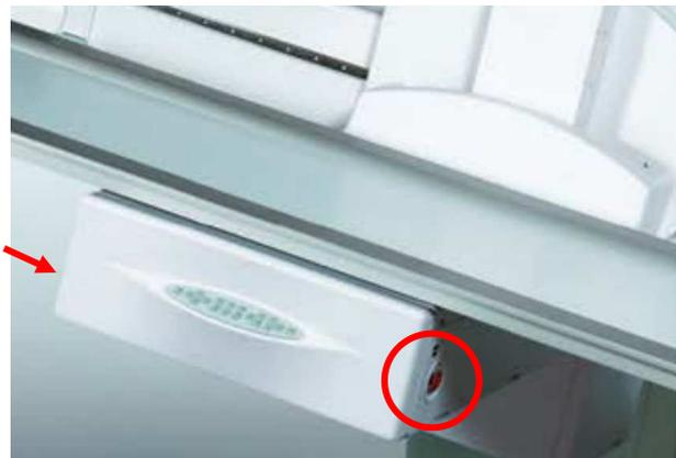
**Boutons d'arrêt d'urgence sur le support du capteur**
