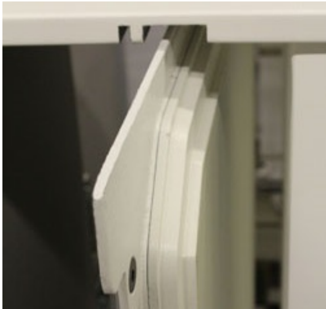
Vue rapprochée sur un collimateur mal aligné.
