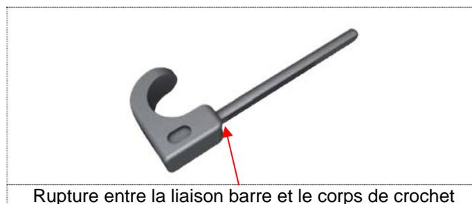
Dans le cas de ces incidents, le crochet et le contre-crochet ont été assemblés entre 2 vertèbres en haut de montage alors qu'il est destiné à être assemblé sur une seule vertèbre. La vertèbre supérieure qui n'est pas reliée au montage peut ainsi être soumise à des petits mouvements qui mettent en sollicitation le contre-crochet et peuvent provoquer sa rupture.
