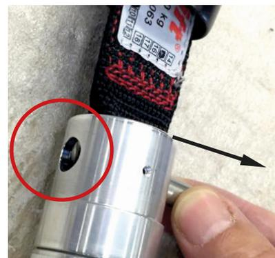
**2. Retirez le boulon de sécurité et la courroie. Si le trou de boulon est endommagé, contactez votre revendeur local.**
