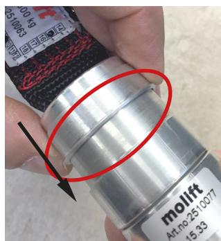
**5. La bague de sécurité est placée sur le couplage. Assurez-vous que la bride est face vers le bas. Vérifiez que les pièces ne présentent aucun défaut ou déformation.**
