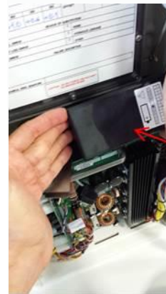
Batterie au plomb inclinée afin de permettre son extraction du bloc d'alimentation
